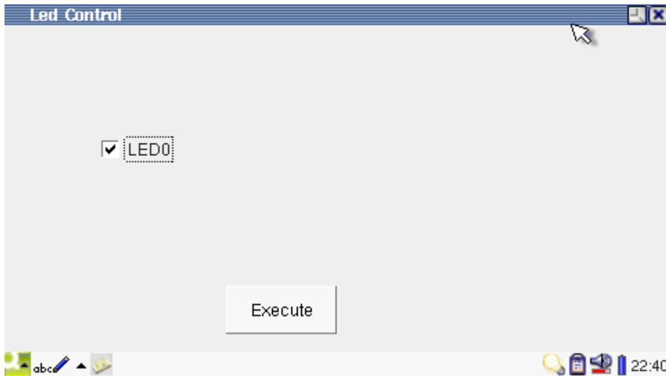
勾选 LED0，再点 Execute，开发板上的 LED 灯（1.3 节图中 ⑳）应该会相应的亮灭。重新选中或者取消选中，再点 Execute，如果板上的 LED 灯有相应的反应的话，则测试通过。本程序源码在软件包目录：Helper2416/source/tests/led\_control。
