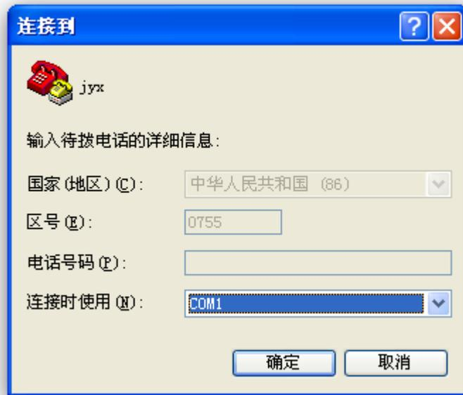
选中与开发板连接的串口，再确定，如果在“连接时使用 (N)”处，没有 COM 选项，请确认 PC 机是否有串口设备，如果没有，可以使用 USB 转串口线。
